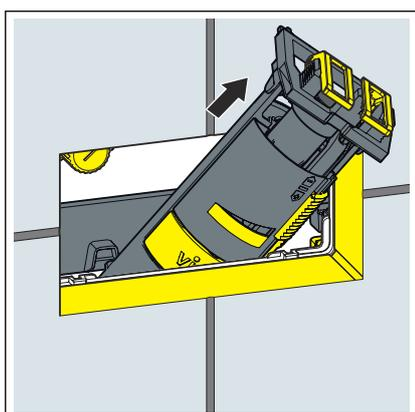
► Das Ablaufventil durch die Revisionsöffnung entnehmen.
