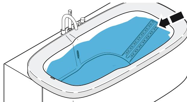
■ Compruebe que los inyectores de las boquillas situadas a lo largo del perímetro de la bañera estén abiertos.
