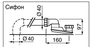
**ПРИМЕЧАНИЕ:** Размеры должны быть определены при окончательно отделанных полу и стенах.
