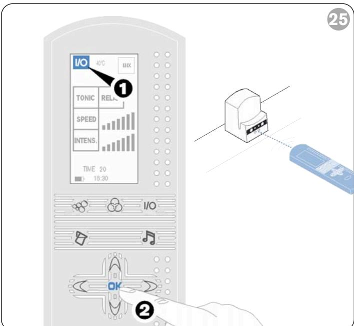
■ Um den Zyklus zu starten, prüfen, ob die Schrift **I/O** oben links blinkt und die Taste **OK** drücken, darauf achten, dass die Fernbedienung auf den Empfänger am Wannenrand (Abb. 25) gerichtet ist: der Zyklus startet und die Led auf dem Empfänger neben dem Symbol **OK** schaltet sich ein.
