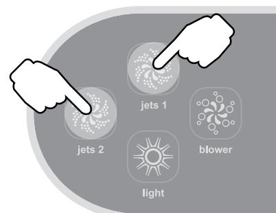
Rabiti ručice (C) za povećavanje i smanjenje snage jet sapnica (jet (1) pridruženi pumpi 1, jet (2) pridruženi pumpi 2).
