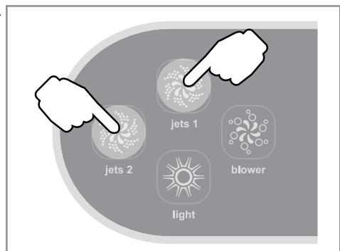
С помощью ручек (C) увеличите или уменьшите мощность струи (струя (1), сопряженная с насосом 1, струя (2), сопряженная с насосом 2).
