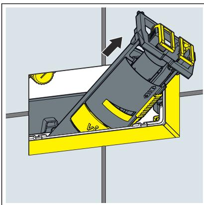
► Das Ablaufventil durch die Revisionsöffnung entnehmen.
