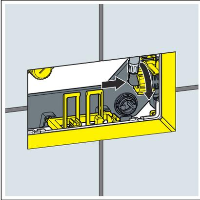
► Den Flexschlauch am Füllventil anschließen.
