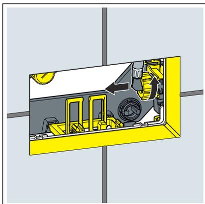
► Den Flexschlauch am Füllventil lösen.
