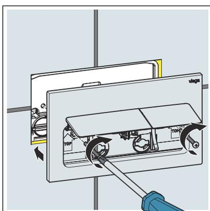
► Die Betätigungsplatte aufsetzen und verschrauben.
