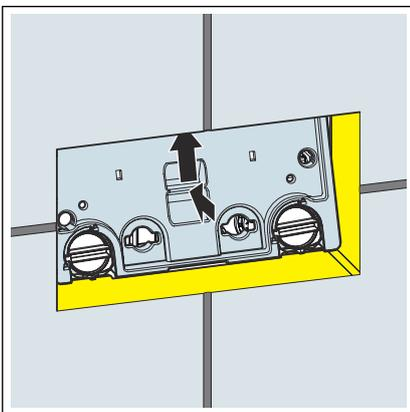
► Die Abdeckplatte in den Spülkasten einsetzen.
