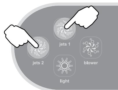
Rabiti ručice (D) za povećavanje i smanjenje snage jet sapnica (jet (1) pridruženi pumpi 1, jet (2) pridruženi pumpi 2).
