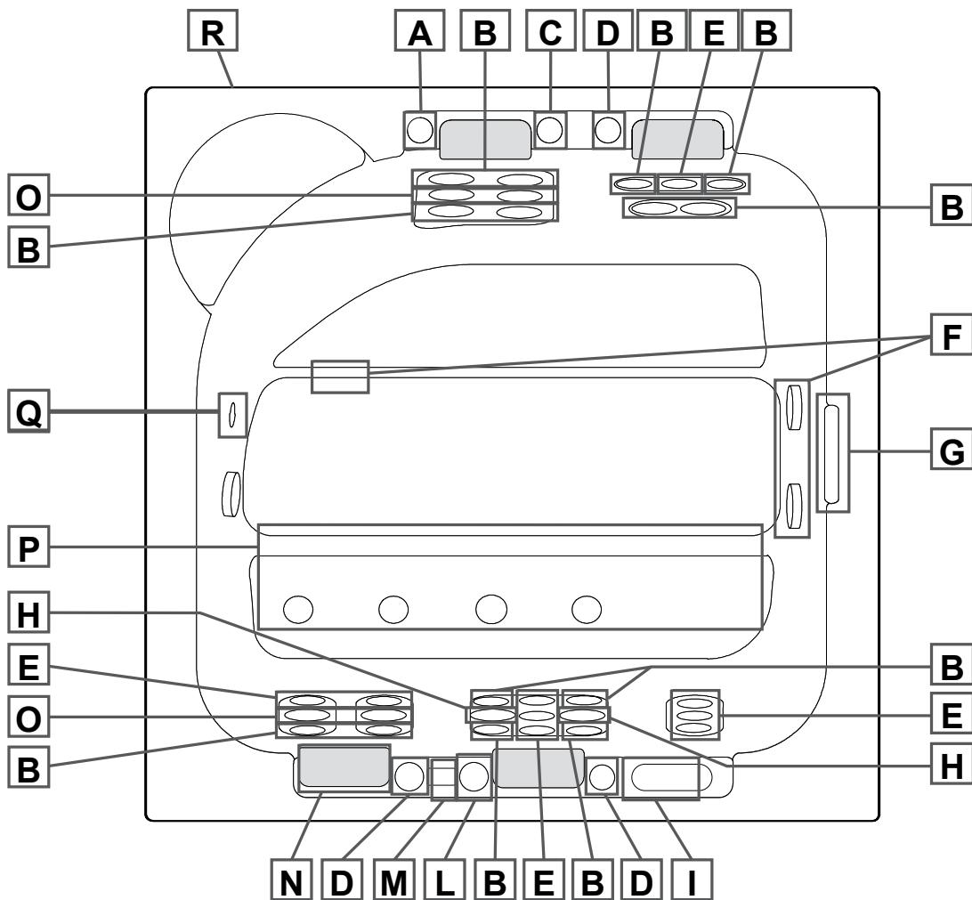
**A - Regulacja strumienia wody:** Pozwala na regulację strumienia wody.
