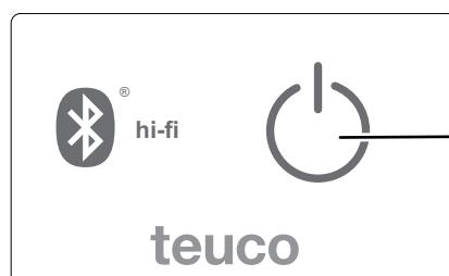
**AUDIO -** Dodirna tipka napajanja sustava ozvučenja.
